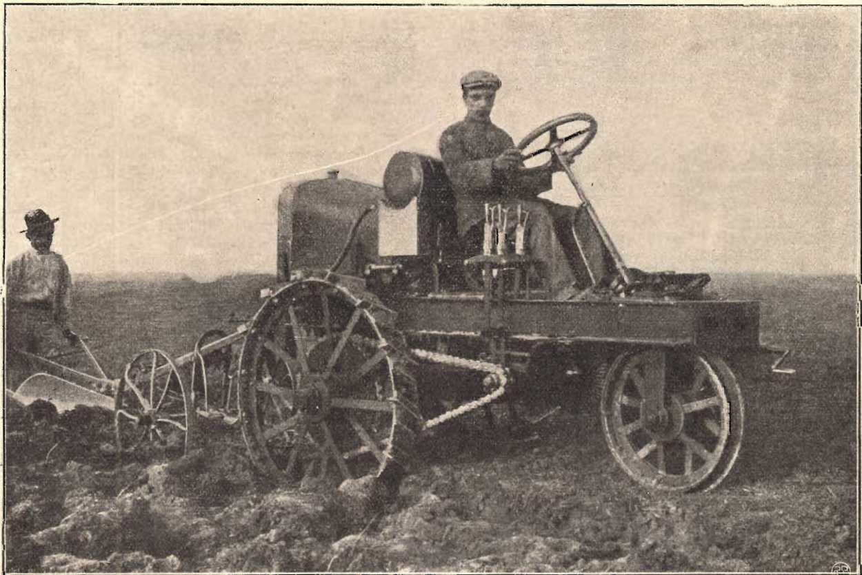
Fig. 7. — Aratrice « Baroncelli »: eseguisce lavoro di rinnovazione oltre i 40 cm. di profondità.
